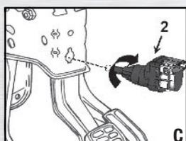
**D - IMPORTANTE:** Debe oír un clic cuando el interruptor se gire hasta la posición correcta. Esta acción cierra el ajuste del émbolo. El interruptor está bien montado, cuando el borne interno (flecha blanca) del interruptor de freno está bien situado al final de la ranura del armazón externo (flecha negra).
