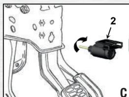
**C** - Mantener el pedal de freno en su posición de reposo.
